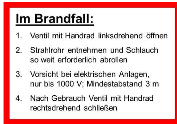
Abbildung 4 Bedienungsanleitung Wandhydrant © Feuerwehr Esslingen a. N.
