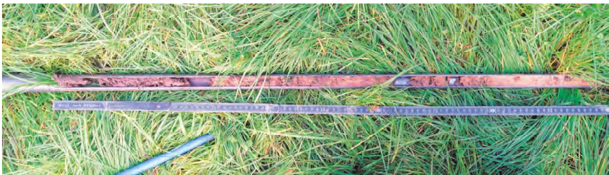
Abb. 4: Kartierpunkt ISP09 (pseudovergleyte Parabraunerde) mit lagerichtigem Wiedereinbau von tonverarmtem Oberboden und tonangereichertem Unterboden. Im Unterboden zeigen sich Staunässemerkmale.
