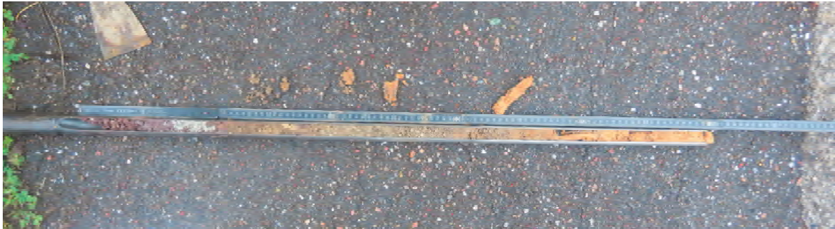
Abb. 6: Kartierpunkt ISP02 (Auftragsboden) mit einem rein mineralischen Auftragshorizont anstelle eines humosen Oberbodens und hohem Steingehalt im Unterboden
