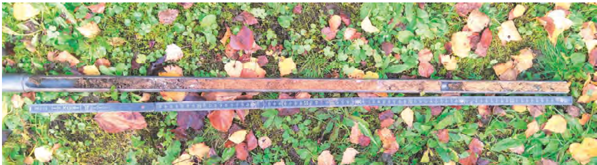
Abb. 7: Kartierpunkt ISP08 (Auftragsboden, naturnah) mit einem verhältnismäßig geringen Steingehalt und natürlichem Bodenmaterial im Unterboden
