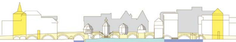
Rekonstruktion und verborgene Teile der Inneren Brücke
